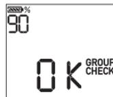
Während dem Aufstarten führt das Gerät einen Selbsttest durch. Scheitert der Selbsttest, wird für 20 Sekunden eine Fehlermeldung angezeigt und Sie werden durch einen akustischen Alarm gewarnt. Beträgt die Batteriekapazität weniger als 20% oder wird das Batteriesymbol angezeigt, müssen die Batterien so rasch wie möglich ersetzt werden!
